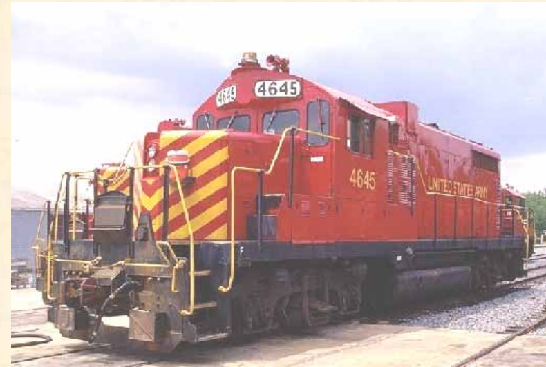
Маневровый локомотив на топливных элементах. Мощность 1000 кВт. США. Проект не завершен.
