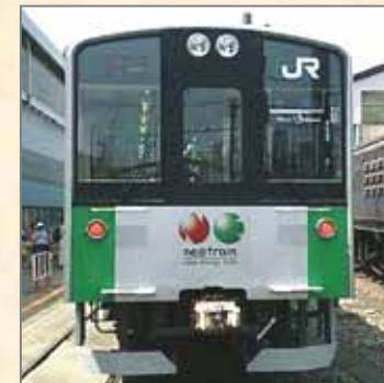
Моторный вагон на топливных элементах. Мощность 130 кВт. Япония
