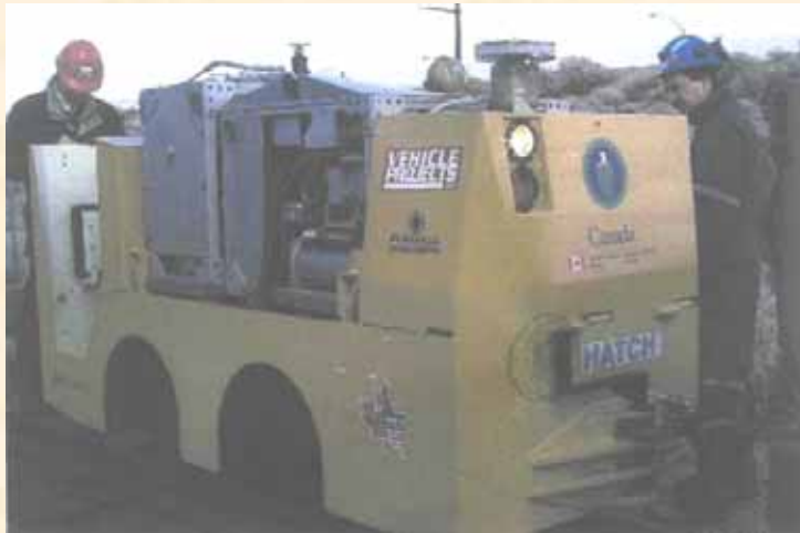
Шахтный локомотив на топливных элементах. Мощность 130 кВт. США.
